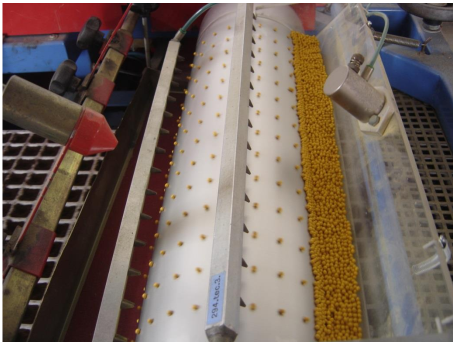
Foto 8: Detalle de rulo de siembra, soplantes y martillos Vista lateral..
