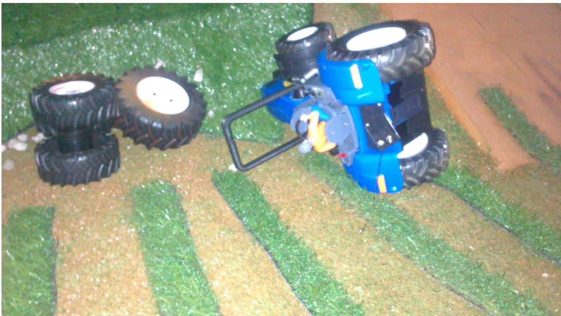
Figura 5. Situación de vuelco con arco de seguridad desplegado a tiempo.
