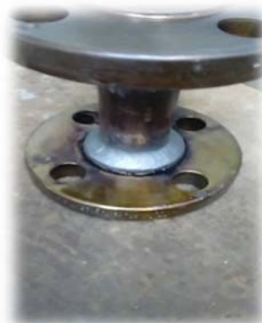
Fig. 3. Costura de Soldadura con Plasma Fuente: Elaboración Propia
