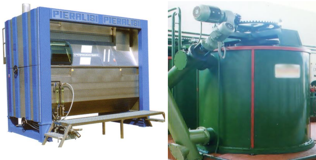
Figura 28 Batidoras de eje Horizontal y Vertical
