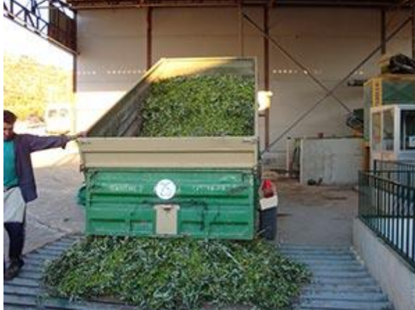
Figura 21 Descarga de aceituna en tolva de recepción
