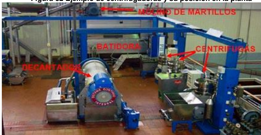
Figura 32 Ejemplo de centrifugadoras y su posición en la planta
