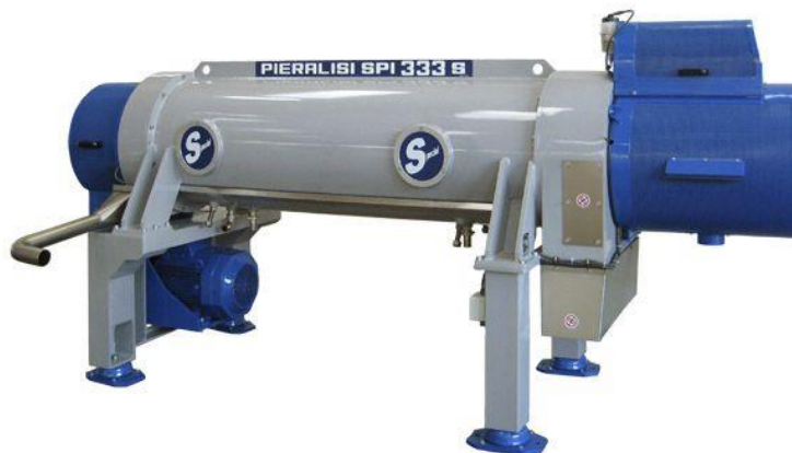
Figura 30 Centrífugadora horizontal 2 fases
