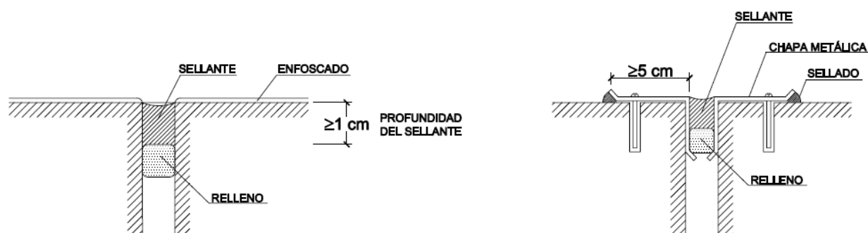
Figura 2.6 Ejemplos de juntas de dilatación
