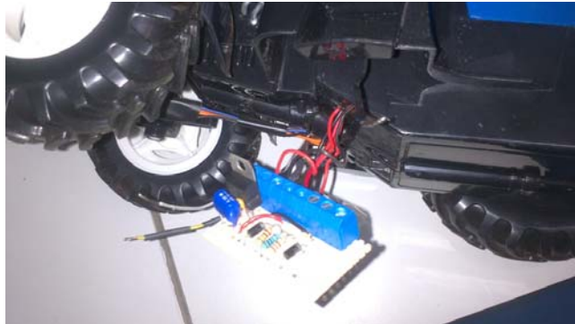
Figura 38. Circuito regulador montado sobre el tractor a escala 1:16.
