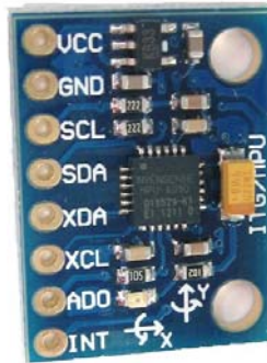
Figura 35. Unidad de medición inercial MPU6050.
