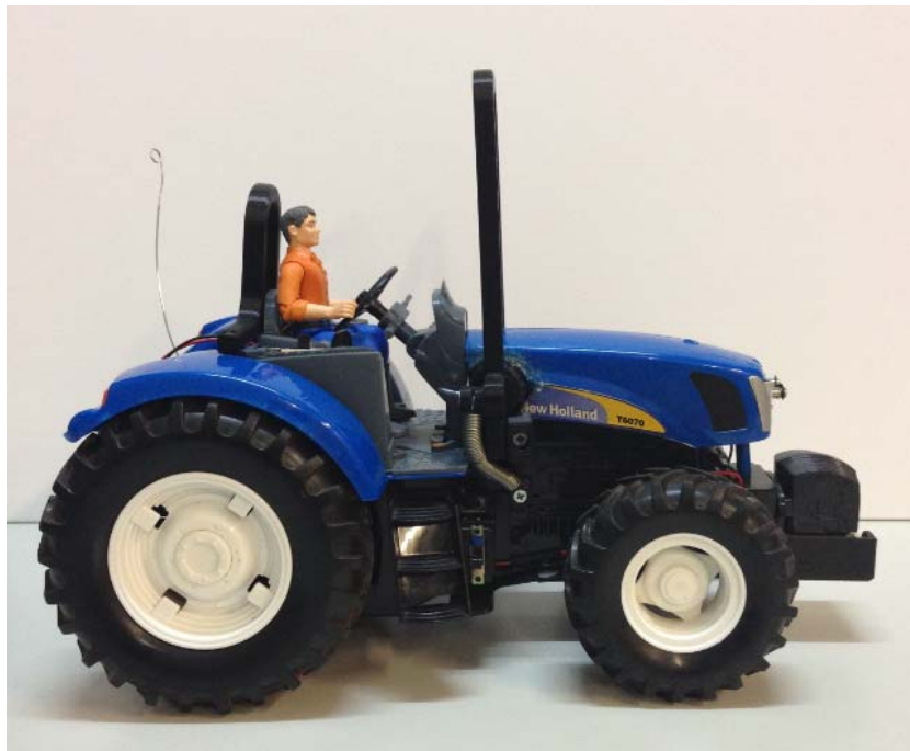
Figura 50. Maqueta modificada con sistemas electrónico y mecánico implementados y con Arco de seguridad elevado.
