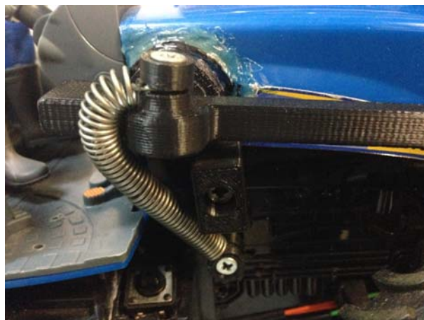
Figura 46. Detalle del elemento de espera (antirretorno) con el arco abatido.
