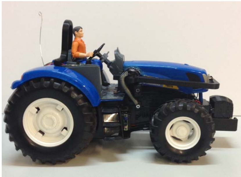
Figura 49. Maqueta modificada con sistemas electrónico y mecánico implementados y con Arco de seguridad abatido.
