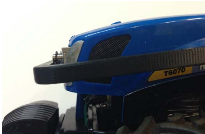
Figura 45. Detalle del arco abatido y sujeto por el vástago alargado del solenoide.
