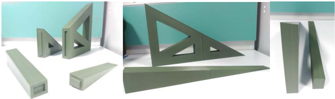
Figura 91. Cuadernas de ABS Plus prototipadas mediante impresión 3D.
