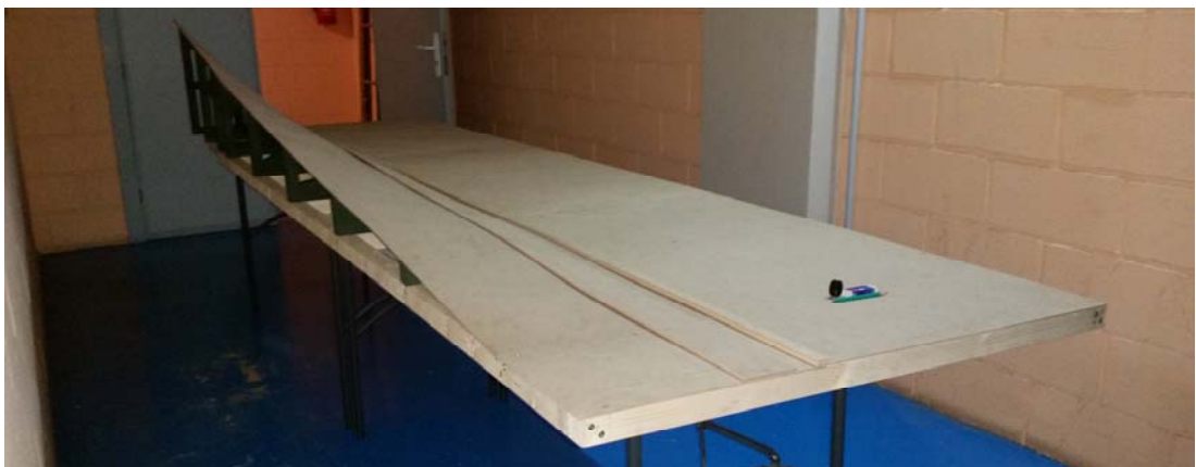
Figura 95. Montaje de bastidor de madera, cuadernas de ABS y chapa de DM.
