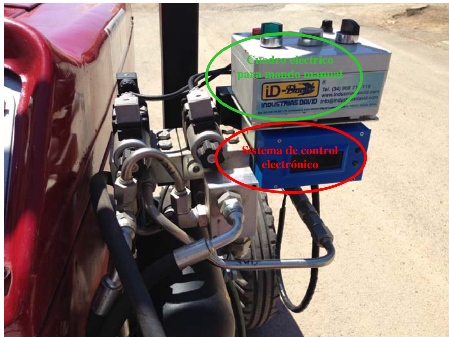
Figura 13. Montaje del subsistema de control electrónico y eléctrico en el prototipo real.
