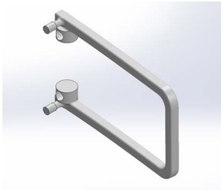
Figura 44. Diseño del arco de seguridad con SolidWorks.
