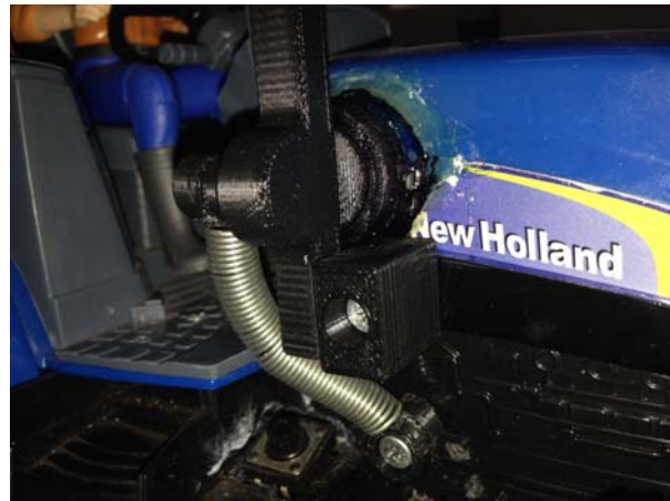
Figura 47. Detalle del elemento de espera (antirretorno) con el arco desplegado.
