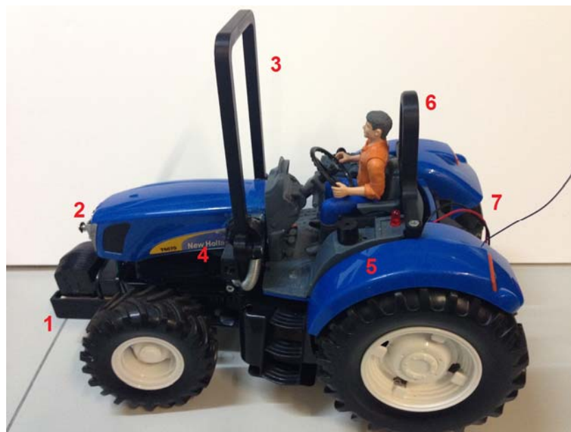
Figura 41. Tractor a escala 1:16 con sistema de seguridad. 1- Alojamiento del microcontrolador. 2- Solenoide. 3- Arco de seguridad. 4- Muelle y tope del arco. 5- Zumbador y led de la alarma. 6- Estructura para garantizar el volumen de seguridad. 7- Alojamiento de la batería.
