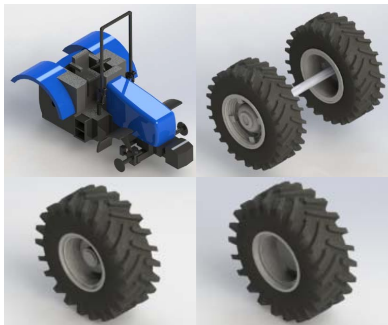
Figura 61. Subensamblajes del modelo completo de la maqueta del tractor.
