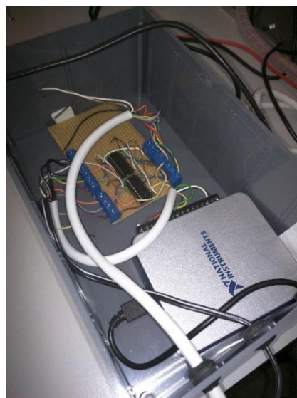
Fig. 4.2 Montaje de la tarjeta de adquisición de datos
