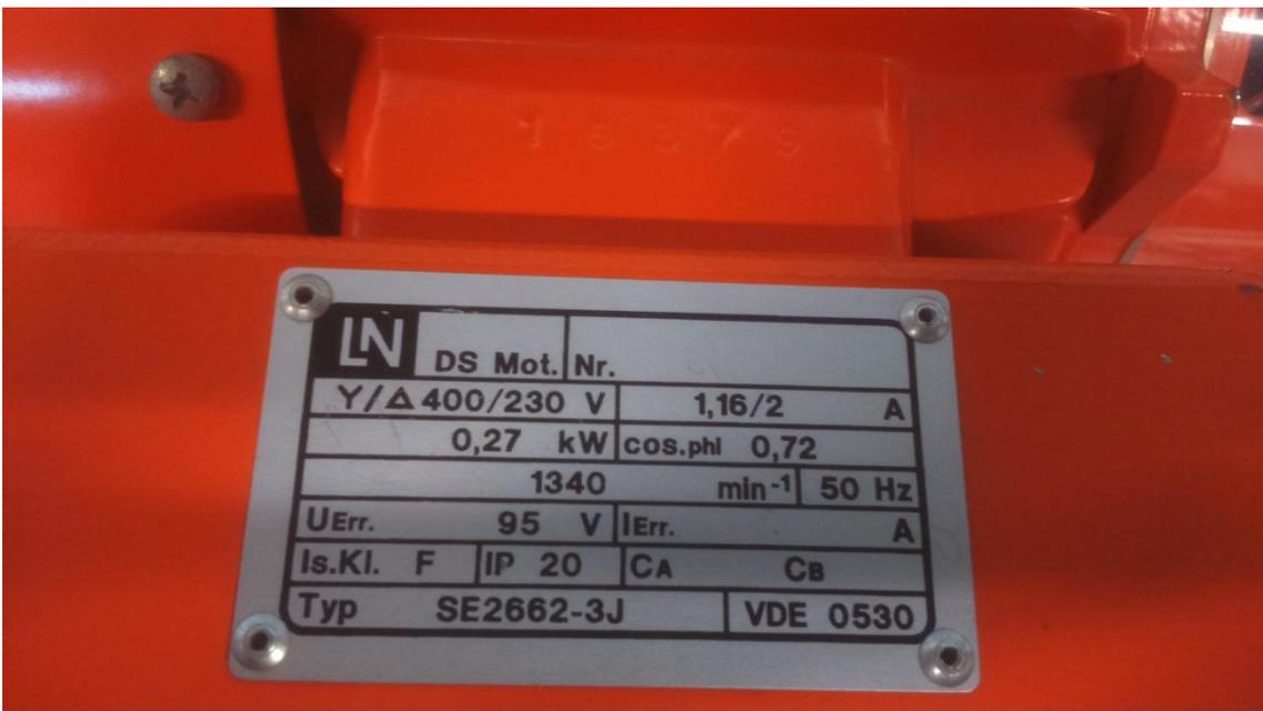
Figura 8: Chapa de características del motor
