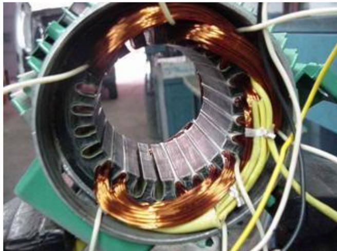
*Figura 1: Estator. Imagen obtenida en el proyecto "Diagnóstico en tiempo real de fallos en motores eléctricos alimentados desde variadores de frecuencia mediante inyección de una señal de alta frecuencia" De la Universidad de Oviedo.*
