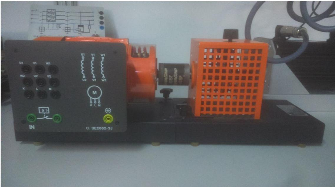
Figura 21: Conexión del freno mecánico al motor
