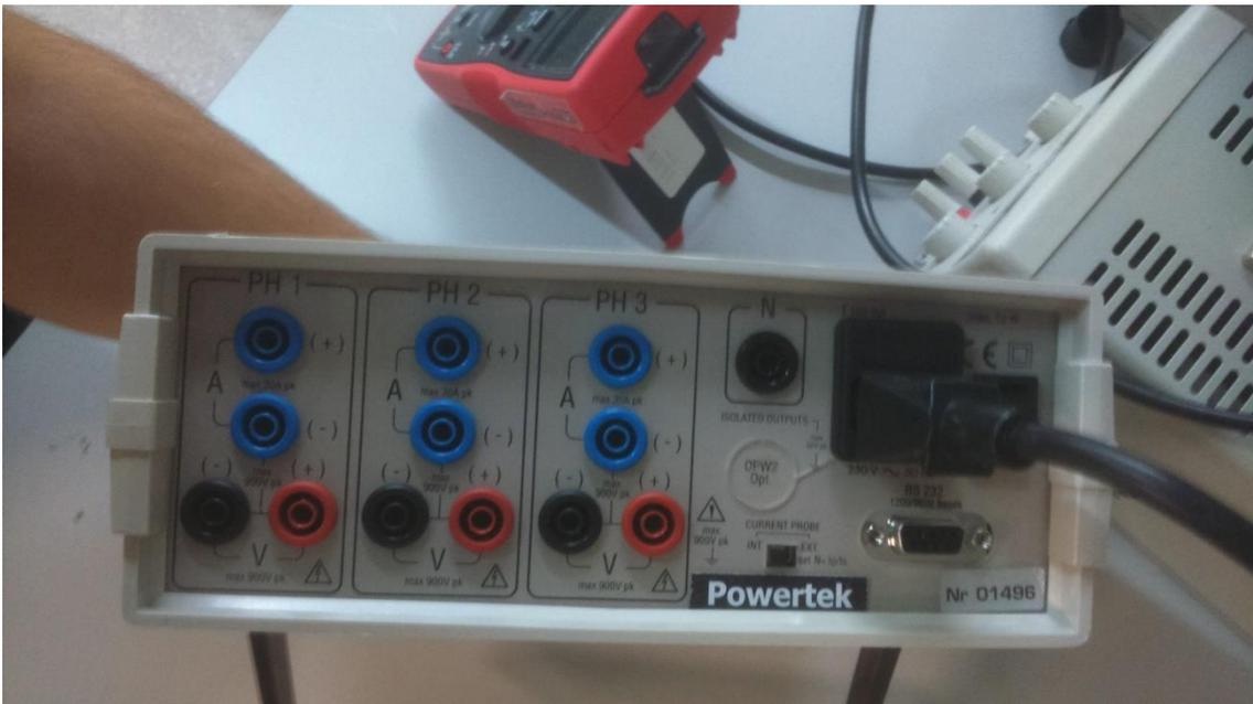
Figura 12: Wattímetro digital. Bornes de conexión
