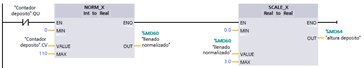
Figura 23: Segmento 2, PLC Depósito.
