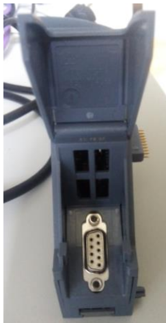
Figura 9: Pestaña inferior de los módulos de comunicación PROFIBUS DP.
