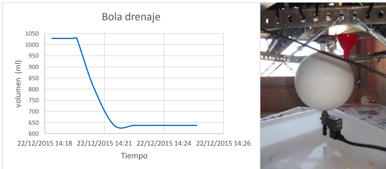
Figura 4.1: Gráfica de vaciado de bola (Izq). Bola de drenaje (Der).
