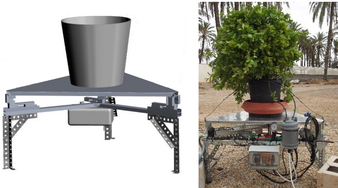
Figura 2.8: Lisímetro de pesada en maceta: Prototipo (Izq), Lisímetro utilizado (Der)
