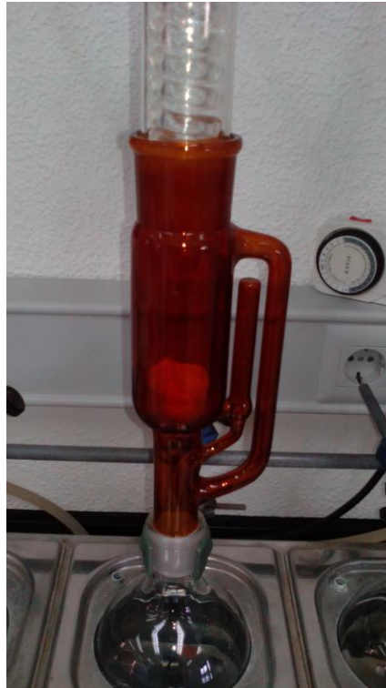
Figura 7: Extractor Soxhlet con balón esmerilado ajustado sobre baño calefactor. En el interior del Soxhlet se encuentra la cápsula porosa con la muestra y el sulfato sódico.
