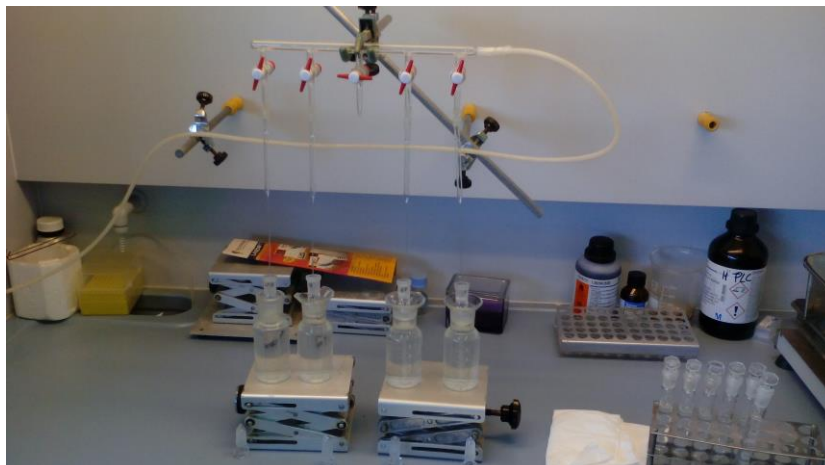
Figura 11: Reducción de la mezcla con corriente de nitrógeno (gas) en una campana de extracción. Se podrán reducir unas 4 muestras por serie de extracción.
