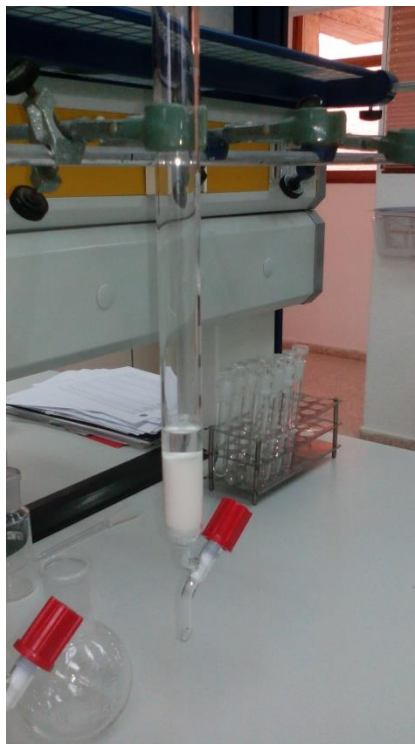
Figura 9: Columna de Alúmina. Se puede observar el filtro compuesto por alúmina, pentano y sulfato sódico.
