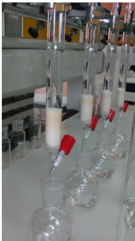
Figura 10: Columnas de Alúmina dónde se puede ver cómo la grasa de la muestra inicial ( Mullus Barbatus ) queda retenida en el filtro.
