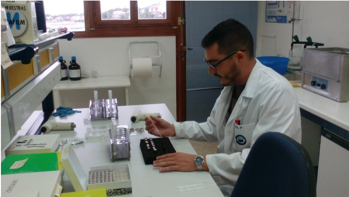
Figura 13: Se vierte la mezcla resultante en viales que se enviarán al Cromatógrafo de Gases para obtener las concentraciones de contaminantes: PCBs (1ªFracción) y DDTs (2ªFracción).
