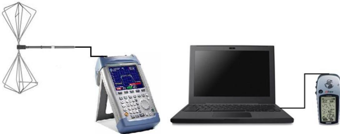
Figura 1: Conexión de los equipos del sistema de medición.
