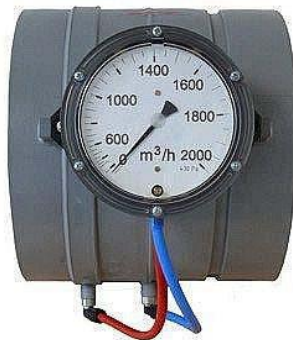
Figura 3.17. Tubo de Venturi
