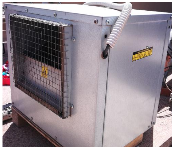
Figura 3.26. Ventilador de aspiración utilizado en panel solar.
