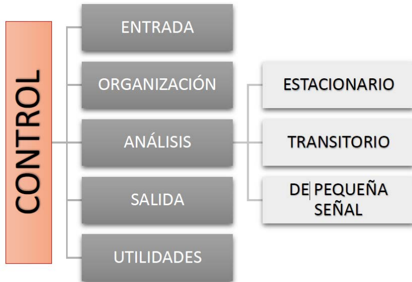
Figura 3.5.1. Diagrama de bloques del programa de simulación de circuitos NGSPICE. Sánchez-Pérez(2012) .
