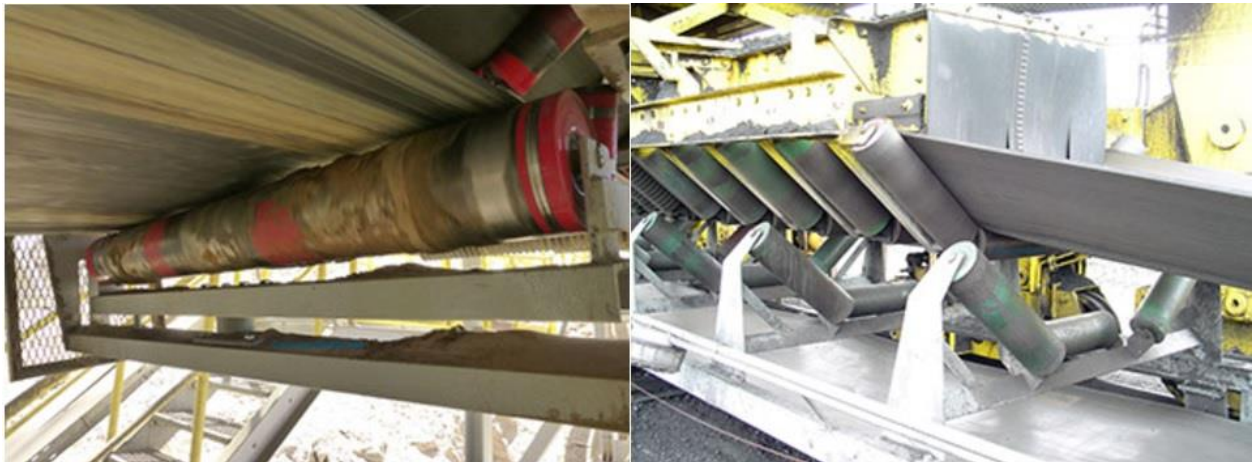
Ilustración 6: Rodillo de retorno (izq.) y rodillo de carga (der.).
