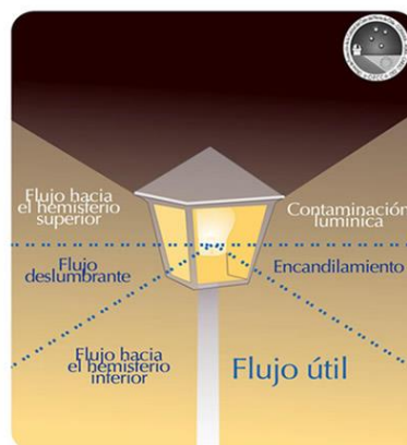
ILUSTRACIÓN 32. TIPOS DE FLUJO LUMINOSO EN FUNCIÓN DE LA DIRECCIÓN
