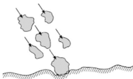
Figura 10. Mecanismo de desgaste por erosión (34)
