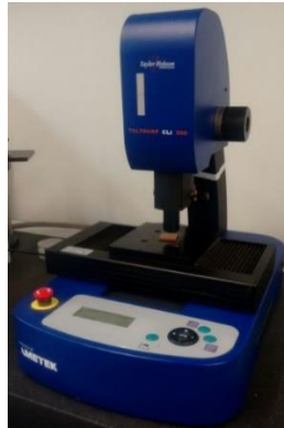
Figura 30. Microperfilómetro Talysurf CLI 500.
