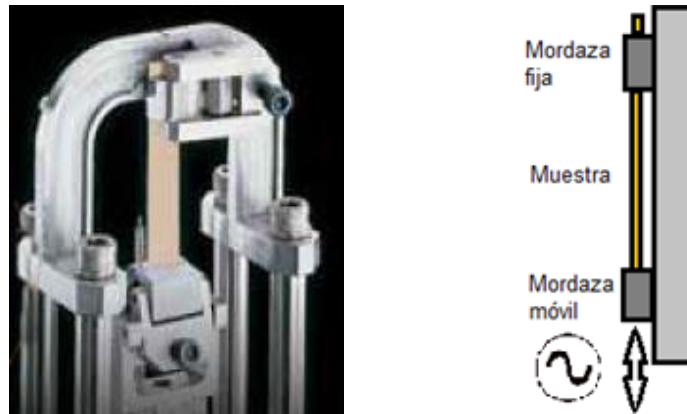
Figura 39. Disposición en modo tensión simple de la carga en ensayo DMA
