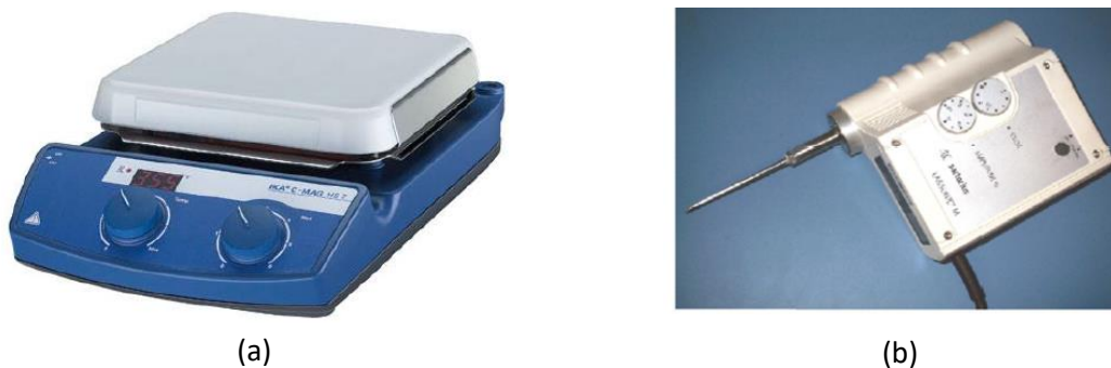
Figura 23. Placa calefactora C-MAG HS 7 (a) y homogeneizador ultrasónico Labsonic M (b)
