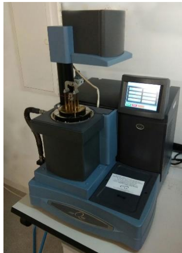
Figura 38. Equipo Q800 de TA Instrument para ensayo DMA
