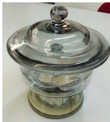
Figura 27. Desecador utilizado en la preparación de films
