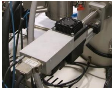
Figura 35. Detector de retrodispersados, modelo e- Flash HR+ de Bruker
