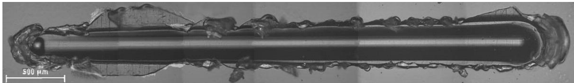
Figura 52. Microscopía de la huella del ensayo progresivo de RE+9%L108
