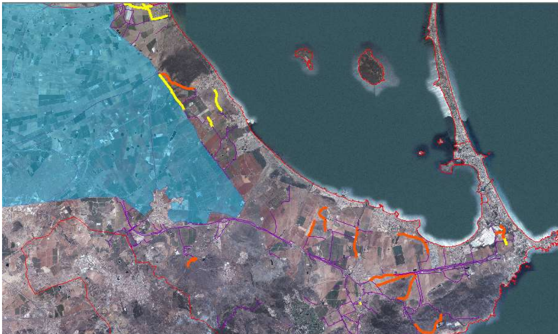
Figura 22. Mapa de caminos en estado grave de degradación. En naranja los caminos con mal bombeo y mal estado de conservación. En amarillo, caminos con mal estado de conservación y sin ningún sistema de bombeo.
