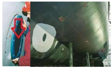
Figura 37: Instalación ánodo de referencia. (Cathelco)
