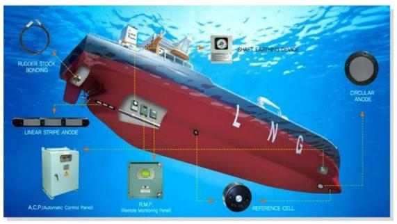
Figura 40: Esquema ejemplo circuito corrientes impresas. (Cathelco)
