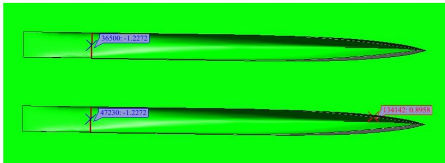
Figura 6.7. Altura de ola máxima y mínima para Fn igual a 0,5.
