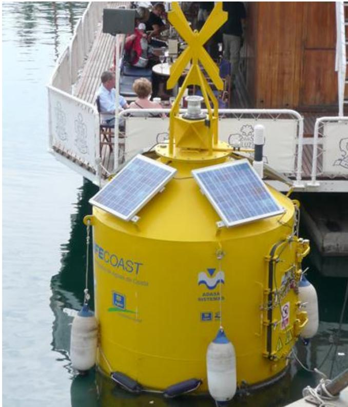
**Fig. 12. Boya con luces alimentadas con energía solar estacionada en puerto**
