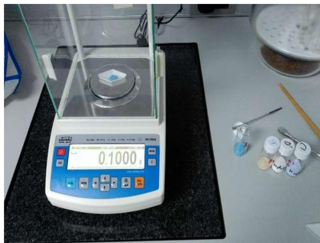
**Fig.17. Pesada de las muestras en balanza de precisión.**
