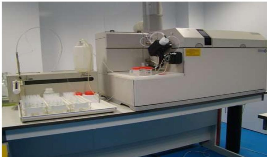
Fig.21. Espectrómetro de masas de plasma acoplado inductivamente AGILENT 7500CE. Fuente: SAIT UPCT.
