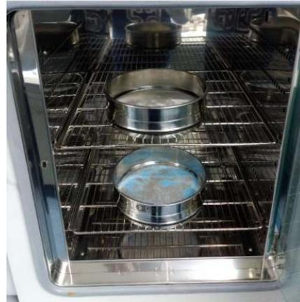
**Fig.14. Horno para la obtención de microplásticos.**
