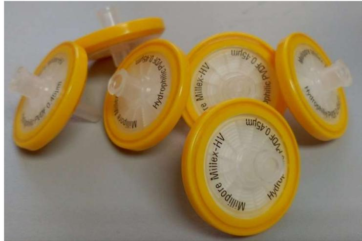
**Fig.19. Preparación de la muestra (filtrado).**
