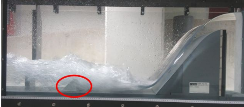
Figura 73. Ejemplo de ensayo realizado con la pieza tipo Ranga Raju
