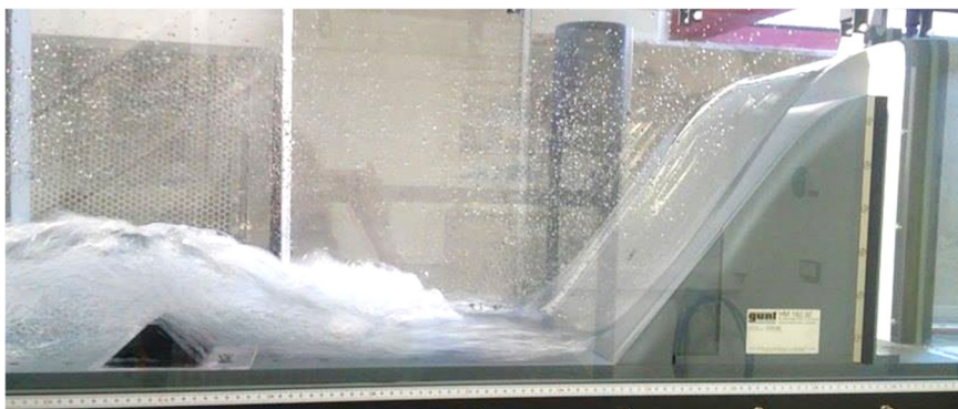
Figura 80. Ensayo realizado con el bloque Lyapin de h=4 cm
