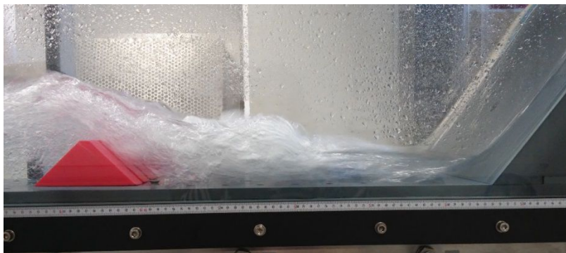
Figura 81. Ensayo realizado con el bloque Lyapin de h = 6\text{cm}
