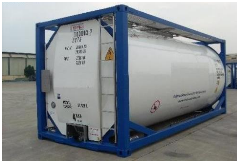
Figura 11. Contenedor granel líquido. Fuente: SoloStocks.
