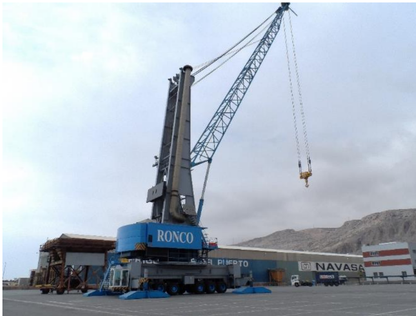
Figura 13. Grúa móvil. Fuente: Autoridad Portuaria de Almería.
