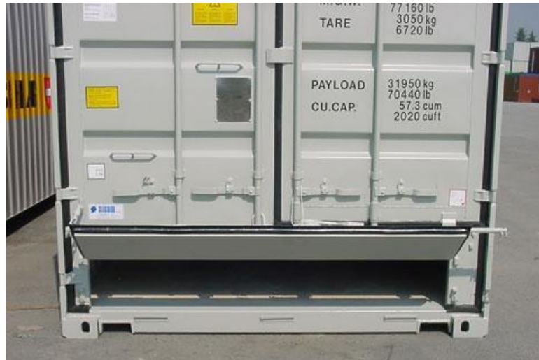
Figura 10. Contenedor granel sólido. Fuente: Ocidenave.
