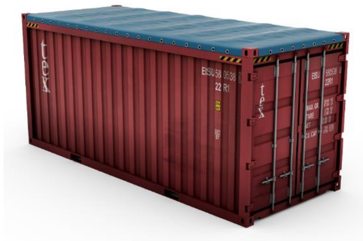
Figura 6. Contenedor abierto por arriba. Fuente: Contraders.
