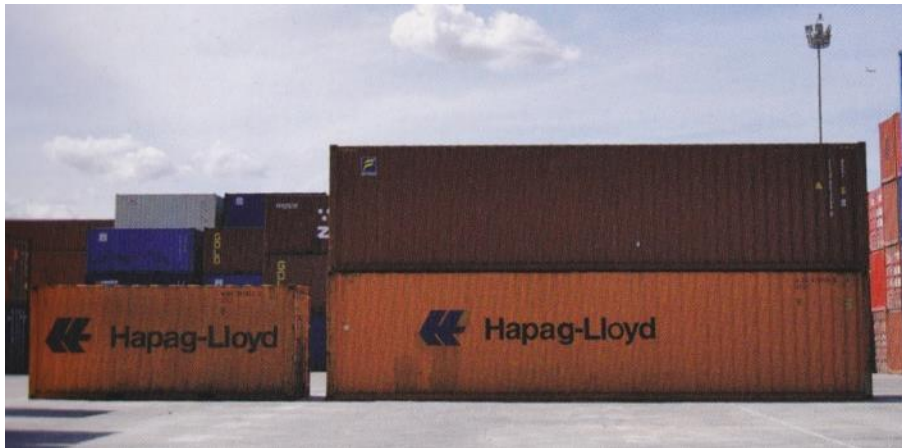
Figura 3. Comparativa entre contenedor de 20 pies (izquierda) y contenedor de 40 pies (derecha). Fuente: Monfort et al (2011).
