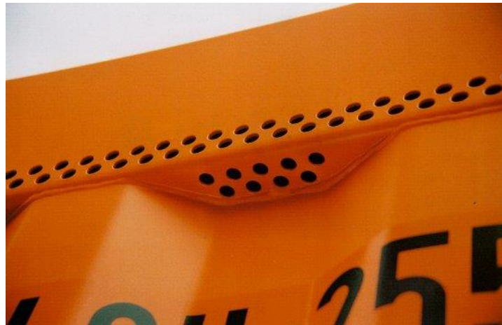
Figura 5. Contenedor ventilado con aberturas en el raíl superior. Fuente: Hapag-Lloyd.
