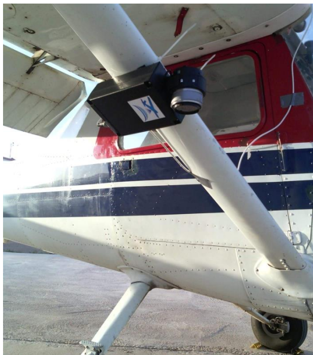
Imagen 12. Equipo de HABITAT-SEREA en el ala de un avión tripulado (Habitat Serea, 2016).
