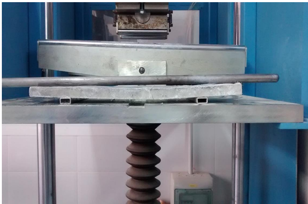
Ilustración 5.8 Probeta A después del ensayo de flexión pura
