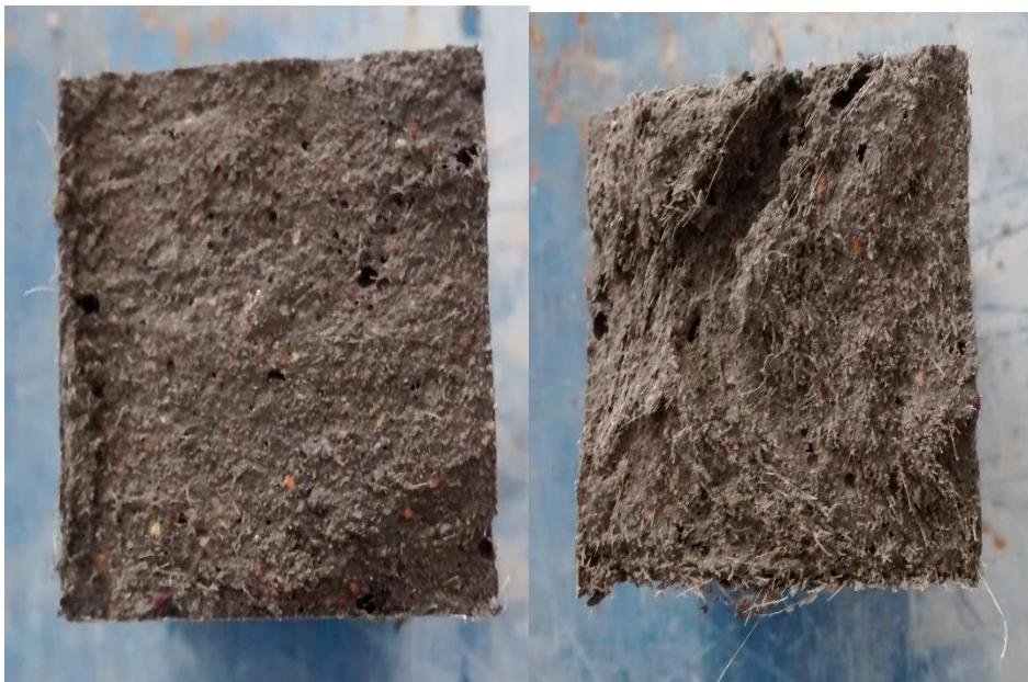
Ilustración 5.5 Plano de rotura a flexión (Izq. muestra A, dcha. muestra B)
