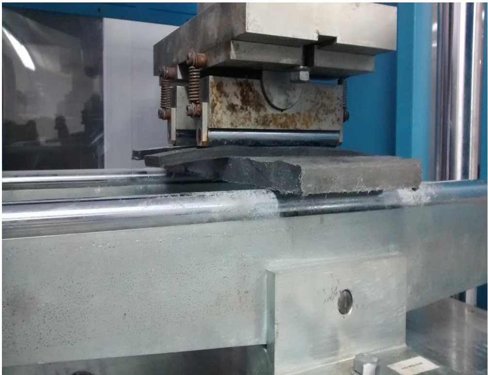
Ilustración 17 Dispositivo montado para el inicio del ensayo a flexión de cuatro puntos
