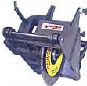
c) Cortadoras manuales: cuyo disco está fijado a un motor (eléctrico) que sostiene el propio operario pudiendo realizar cortes de hasta 600 milímetros.
