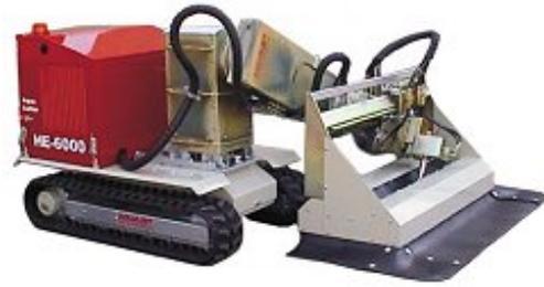
*Dos ejemplos de hidrodemolición: a la izquierda operario retirando el hormigón de una losa, a la derecha otro tipo de maquinaria para hidrodemolición*
