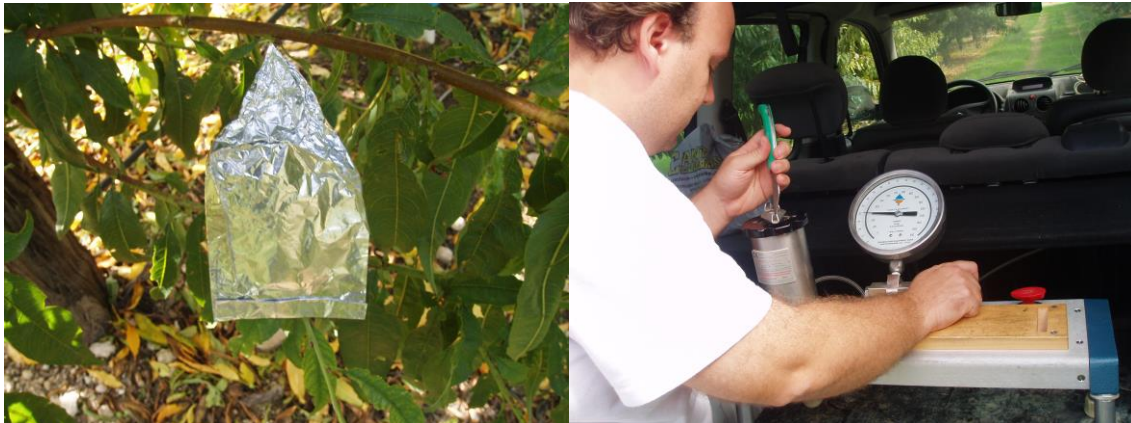
Fotografía 4.3. Hoja tapada y medición con cámara de presión. Soil Moisture Equip. Corp, model 3000, Santa Barbara, CA, USA (Fuente propia).
