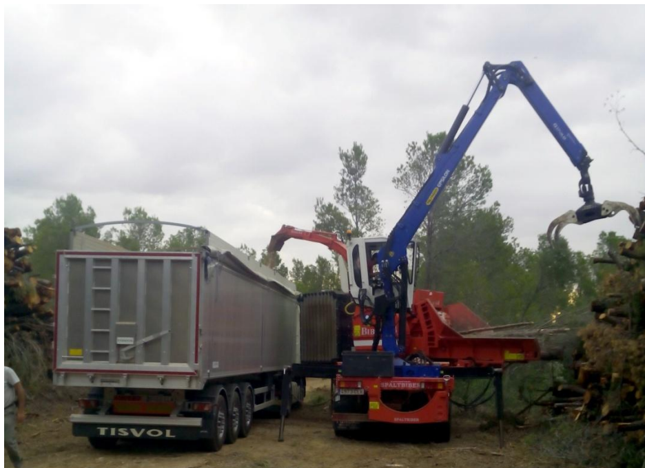
Imagen 21. Maquinaria astilladora de restos forestales.
