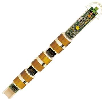
*Ilustración 4.3.2* Sonda EnviroSCAN
