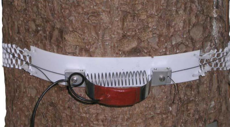
*Ilustración 4.3.1.1 Ejemplo de instalación de dendrómetro perimetral*
