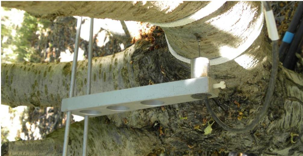
**Ilustración 4.3.2.2** Dendrómetro radial LVDT instalado
