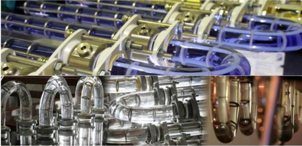
Figura 1.4 OBR a escala industrial, formado por cientos de pasos.
