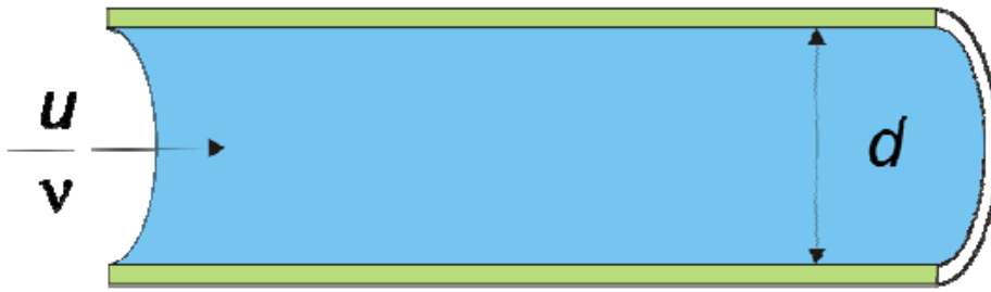
Figura 1.9 El flujo neto en un tubo liso.
