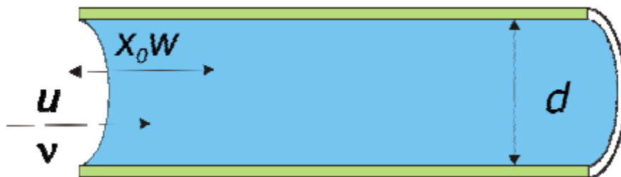
Figura 1.10 Movimiento oscilatorio superpuesto a un flujo neto.
