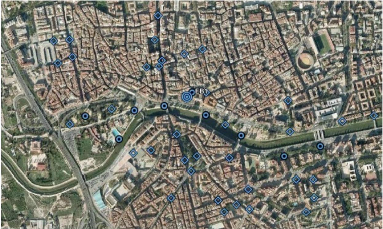
Figura 5.3) Ubicación de los nodos WiFi de la estación base EB1
