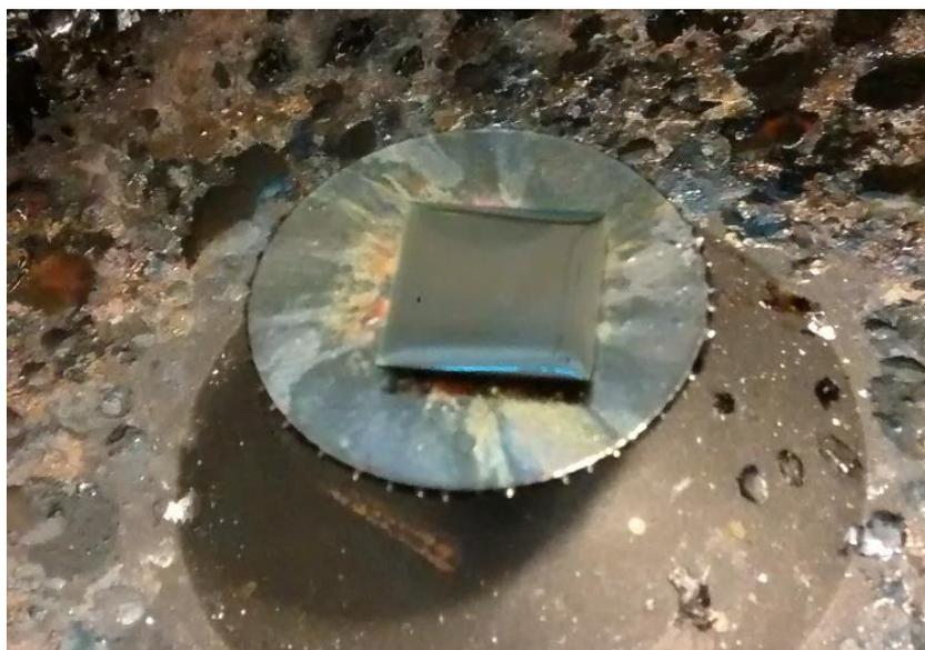
**Figura 20.-** Deposición uniforme de la disolución de capa activa sobre la superficie del sustrato de vidrio/ITO.
