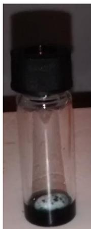
Figura 17.- Vial con 0,5 ml de disolución de capa activa.
