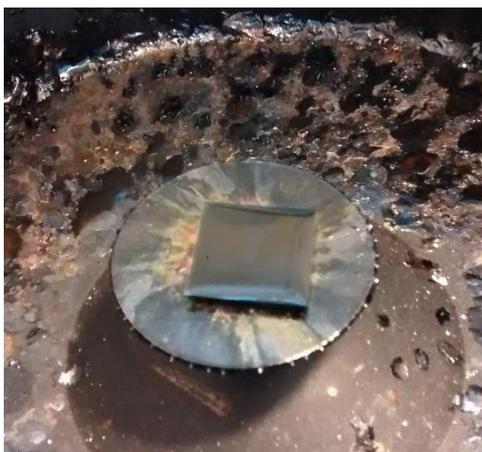
**Figura 13.-** Imagen de un sustrato con disolución de capa activa sobre su superficie y depositado en el equipo de *spin-coating*.
