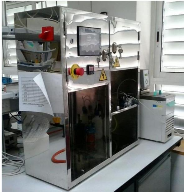
**Figura 4.** Termorresistómetro Mastia
