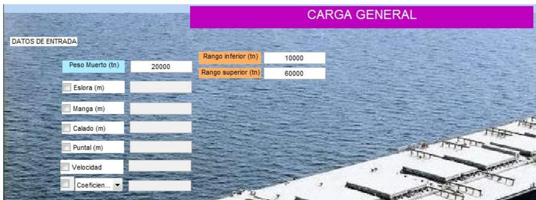
Figura 35. *Pantalla introducción de datos en buque de Carga General*
