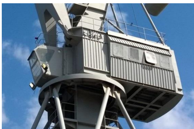
Figura: 10 Caseta de mecanismos y cabina de mando
