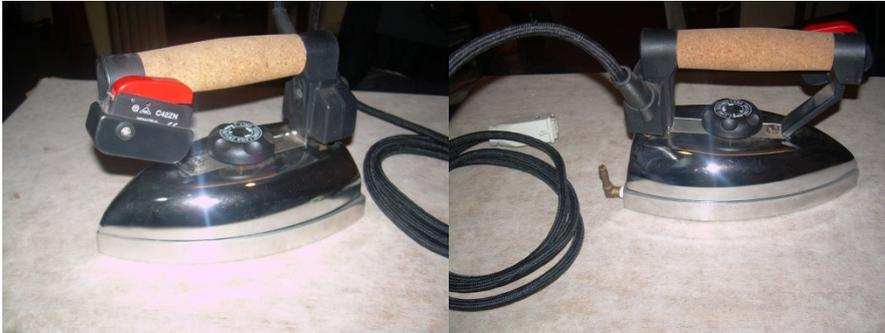
Se trata de una plancha industrial Netmac 073 con superficie de inoxidable taladrada para permitir la salida de vapor y con una resistencia eléctrica interior para mantener una temperatura adecuada en contacto con el textil.
