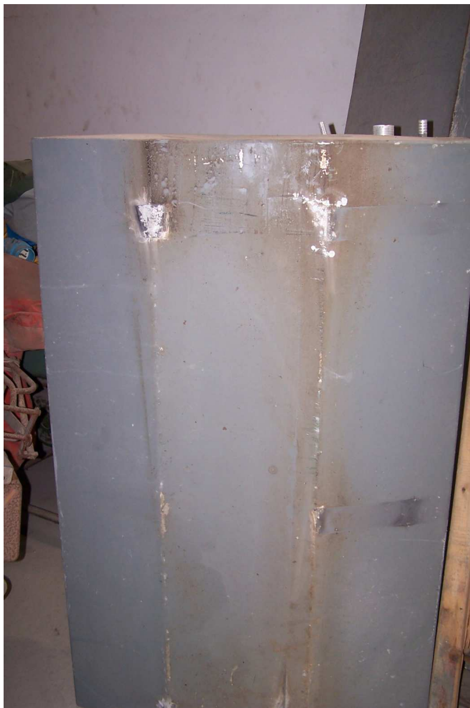
Figuras 39 y 40: En estas dos imágenes se aprecia la corrosión en un depósito de aluminio idéntico al del buque Barba.
