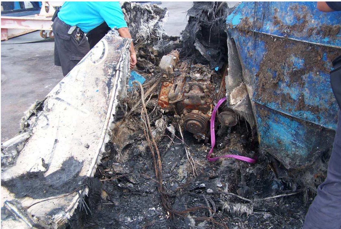
Figura 14: Restos de un motor a popa.
