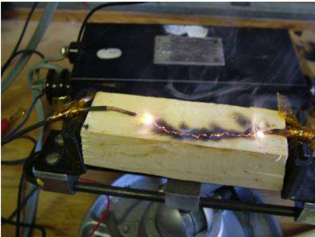
Figura 13: Efecto de un arco de corriente cerca de un taco de madera.
