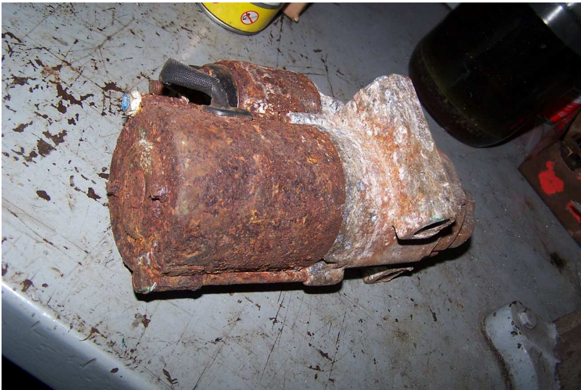
Figura 42: Bomba de combustible totalmente corroída.
