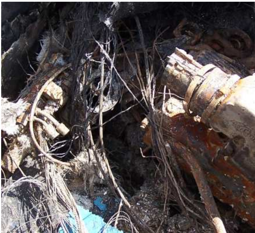
Figura 11: Restos del cableado en la embarcación Barba tras su reflotamiento.
