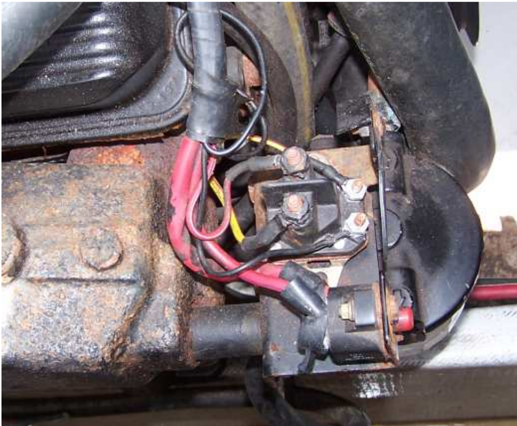
Figura 24: Corrosión en un motor de una Baja 290.
