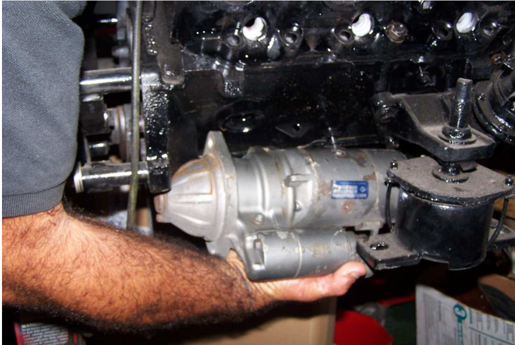
Figura 43: Motor de arranque suelto.
