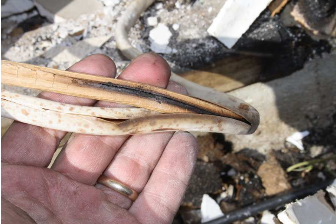
Figura 12: Aislamiento de un cable desprendido debido al calentamiento del cable.
