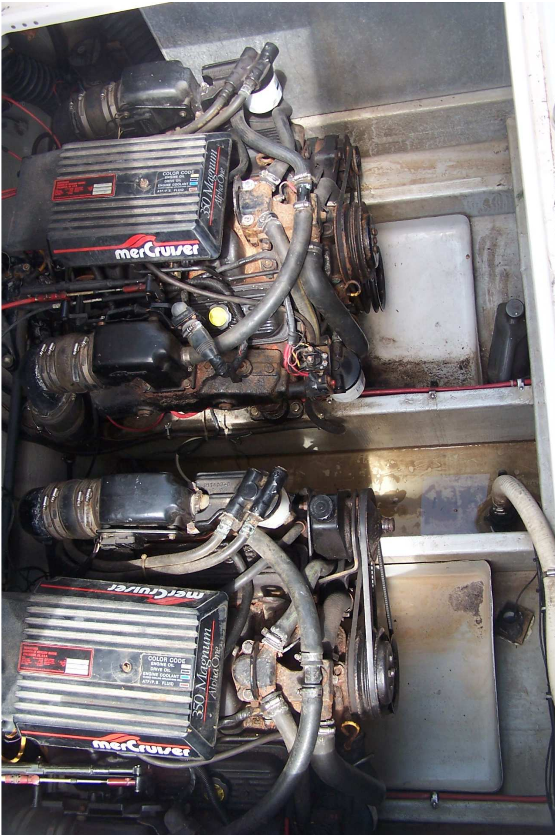
Figura 10: Motores de una embarcación Baja 290 falta de mantenimiento.
