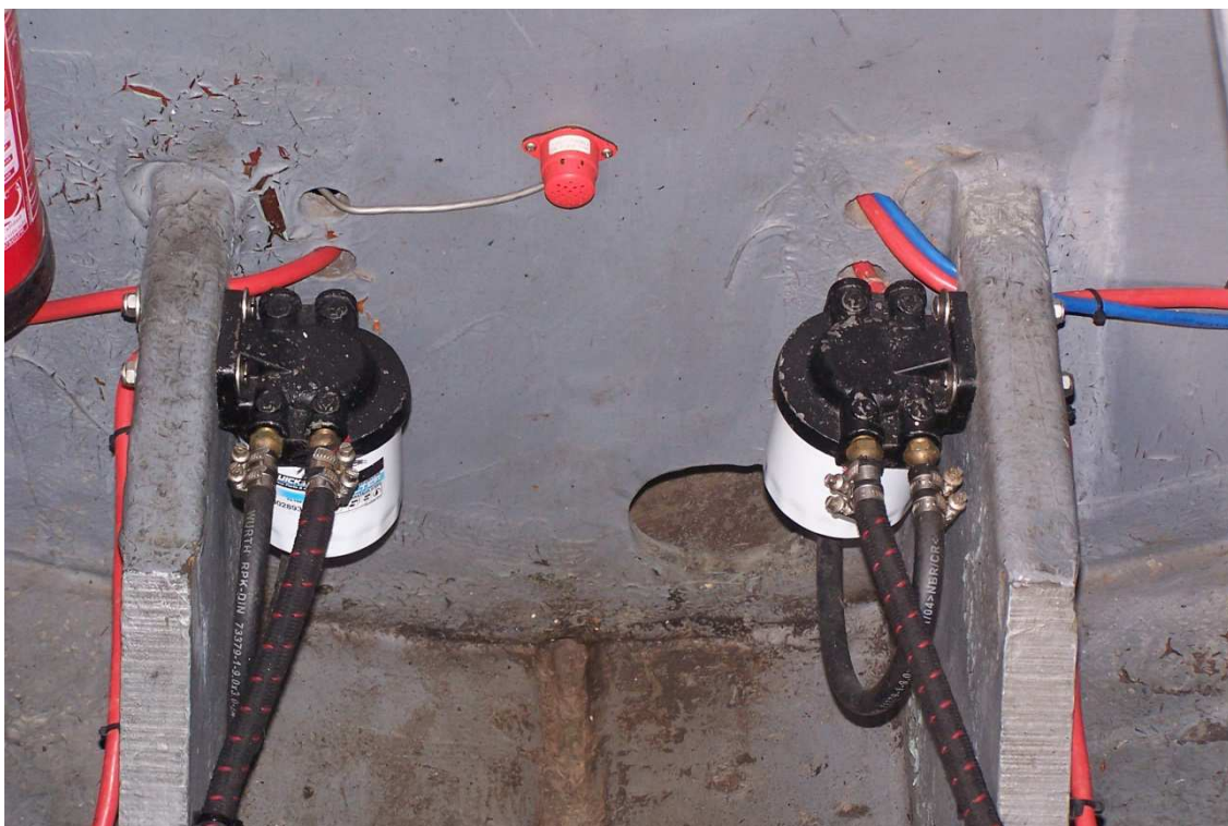
Figura I5: Detector de gases inflamables a proa de la cámara de máquinas de un buque similar al Barba.
