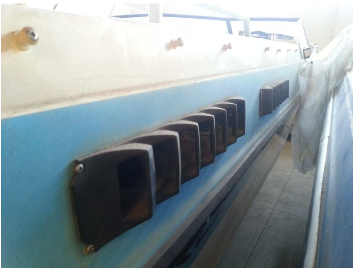
Figuras 54 y 55: Motor del extractor a proa de la cámara de máquinas y rejillas del extractor en la banda de estribor.
