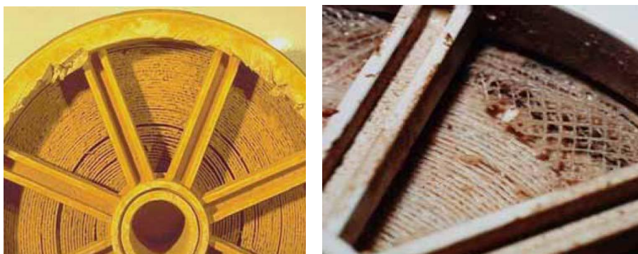
Figura 4.10. Telescoping y rotura de la membrana (DOW, 2009)
