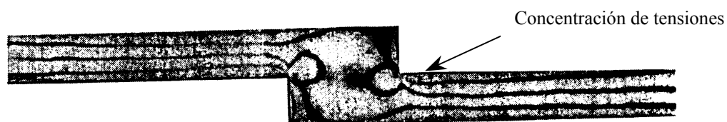
Figura 3.2 medida de tensiones por celdas fotoelásticas.
