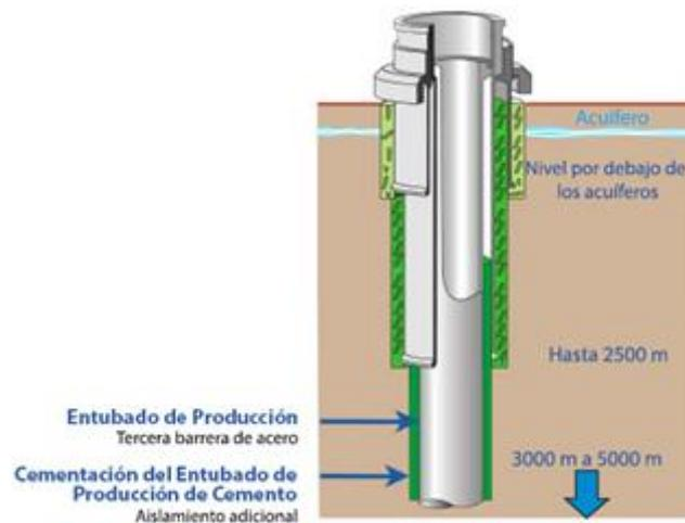
Figura 16. Entubado de producción y cementación de alta resistencia.
