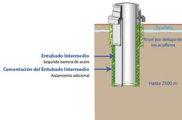
**Figura 14.**Entubado intermedio y cementación de alta resistencia.
