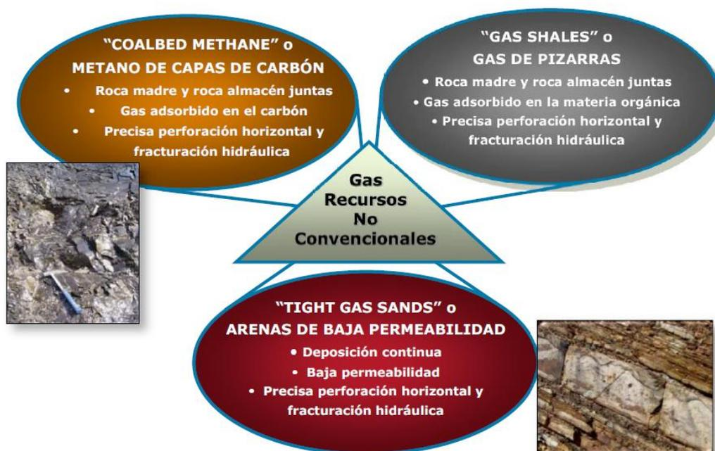
Figura 9. Gas No-convencional: gas de pizarra, gas en capas de carbón y gas de baja permeabilidad
