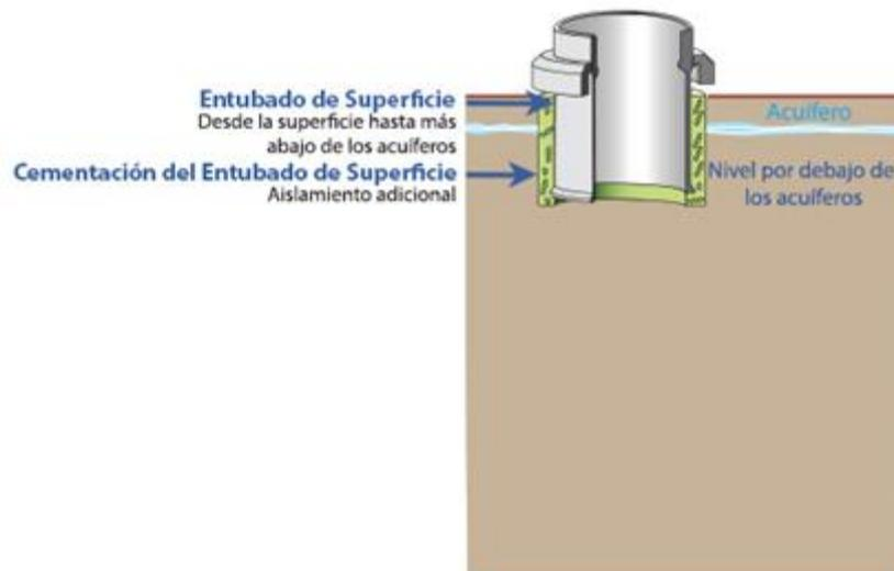
**Figura 13.**Entubado de superficie y cementación de alta resistencia para proteger los acuíferos.
