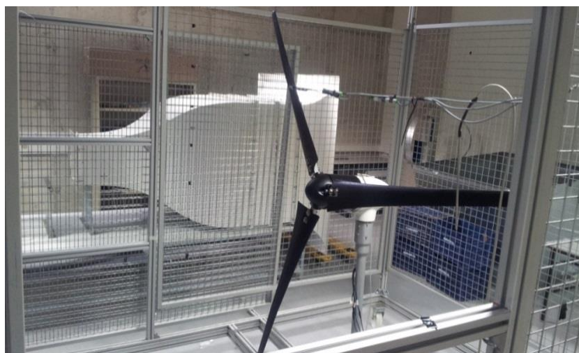
Figura 4-5 Aerogenerador Whisper 200 instalado.
