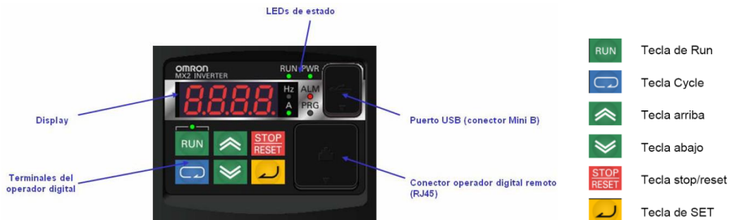
Figura 6-10 Panel de los variadores de frecuencia.
