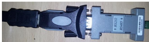
Figura 6-4 Conexión de los adaptadores USB a RS-232 con RS-232 a RS-485.
