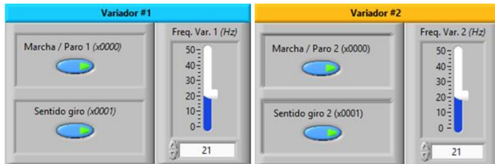
Figura 7-21 Control de los dos variadores en el panel frontal del VI desarrollado.
