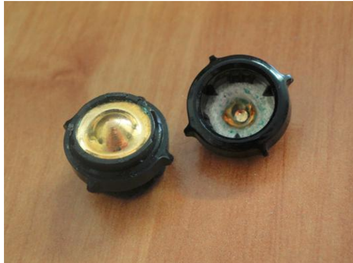
Figura 2.6: Electrodo Emotiv Epoc oxidado.
