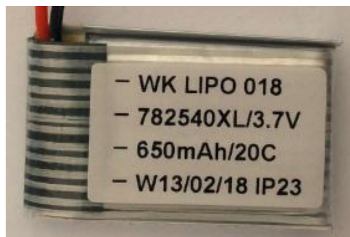
Figura 3.6: Batería LiPo 650mAh/3,7V.
