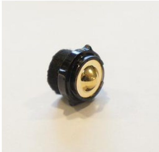
Figura 2.2: Electrodo de contacto con almohadilla y parte de contacto eléctrico visibles.
