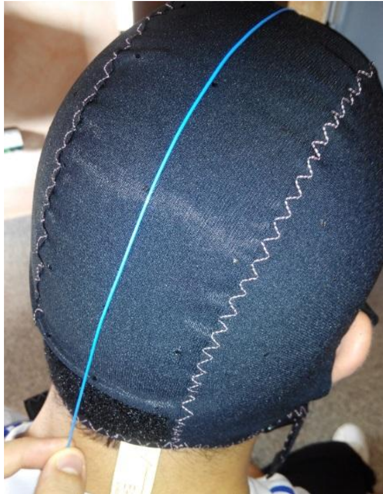
Figura 3.14: Determinación de longitud de cableado de los sensores.
