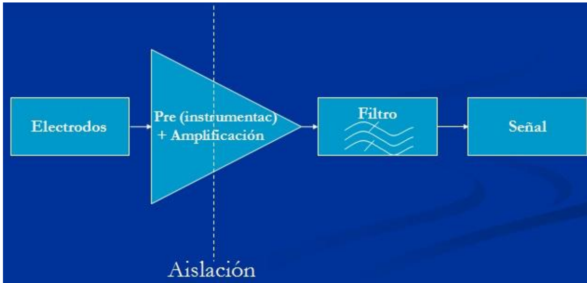
Figura 2.1: Partes principales de un dispositivo EEG.
