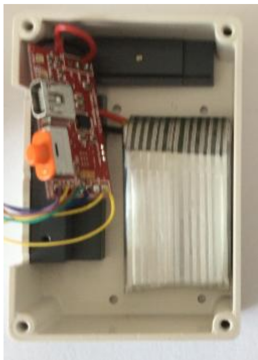
Figura 3.27: Interior de la caja con batería pegada.
