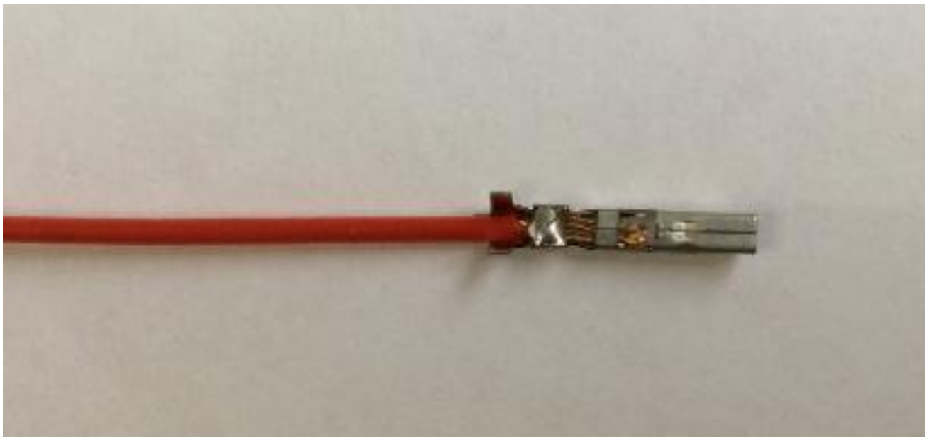
Figura 3.15: Soldadura de conector crimpado.
