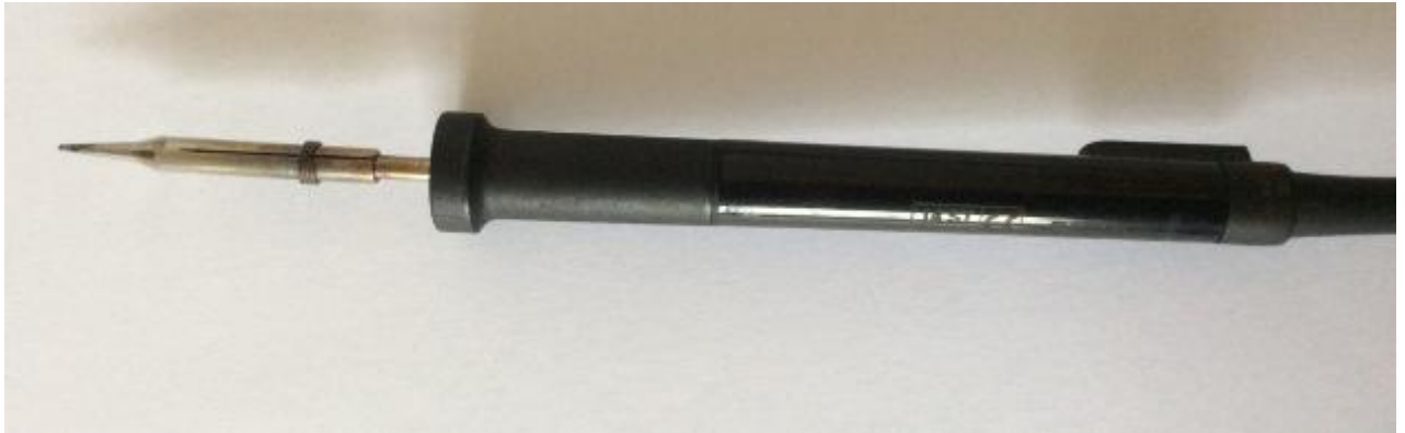
Figura 3.1: Soldador JBC con punta 0,5 mm.
