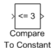
Figura 3.18. Bloque 'Compare To Constant' biblioteca 'simulink' y del bloque 'Logic and Bits Operations'.
