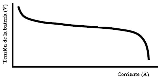
Figura 3.14. Curva característica tensión-corriente de una batería.
