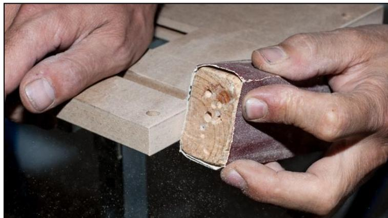
**Ilustración 58. Lijado de desbaste**
