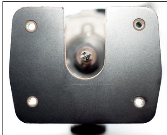
**Ilustración 66. Detalle taladros base fresadora**
