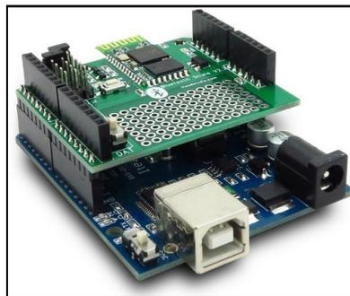
**Ilustración 5. Arduino UNO con shield**
