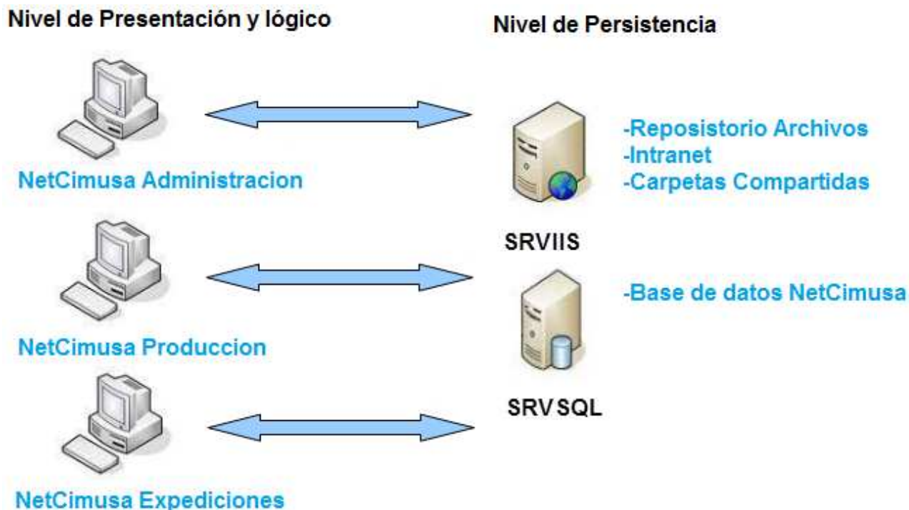
Fig. 3.6 Esquema de la arquitectura general del sistema.
