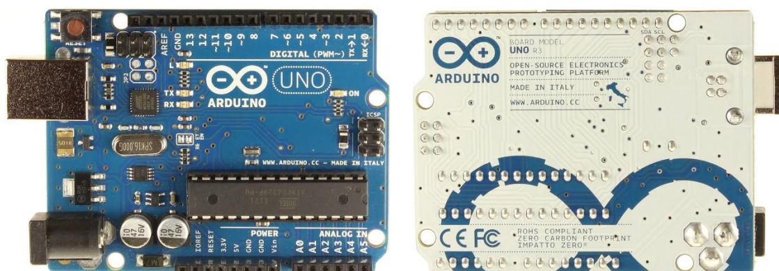
Fig. 3.9 Vista frontal (izquierda) y trasera (derecha) de Arduino UNO (revisión 3.0).
