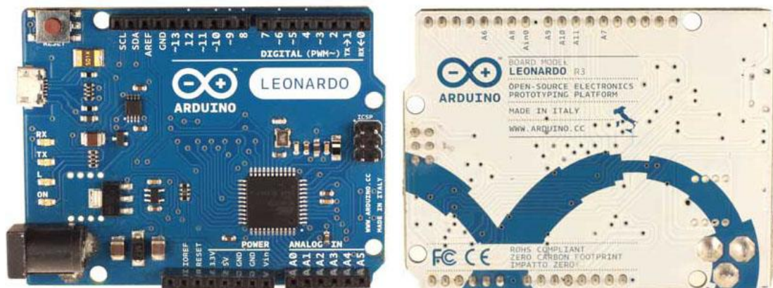
Fig. 3.7 Vista frontal (izquierda) y trasera (derecha) de Arduino Leonardo
