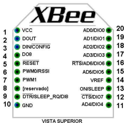
Fig. 3.25 Localización de pines en Xbee Series 1
