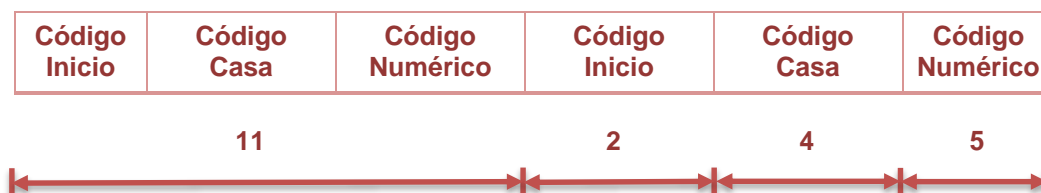
Fig. 2.15 Ciclos totales para una transmisión completa
