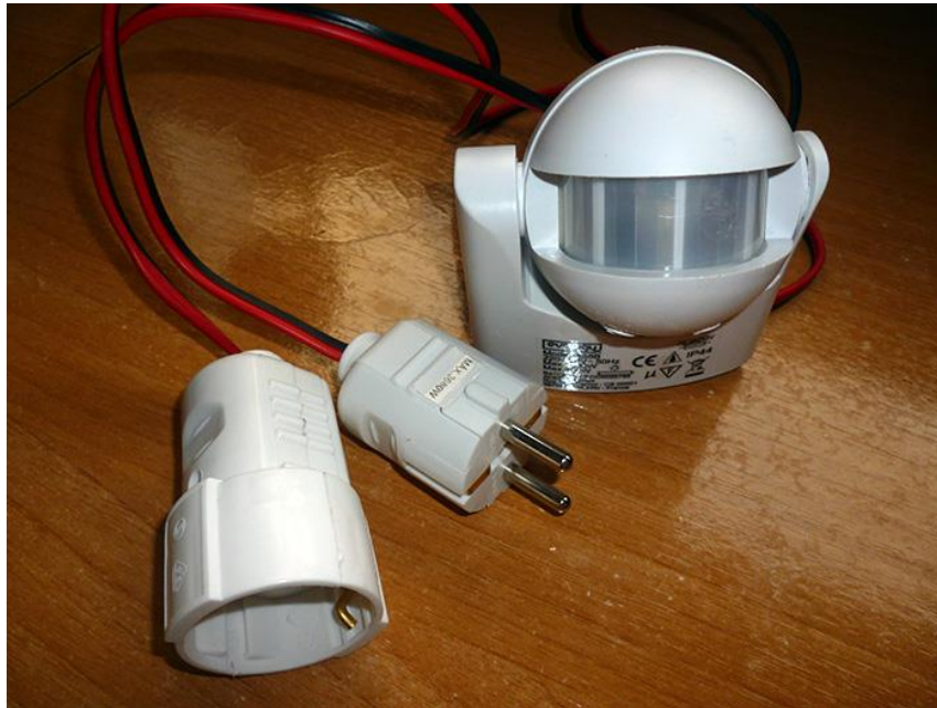
Fig. 4.7 Sensor de presencia con enchufes macho y hembra
