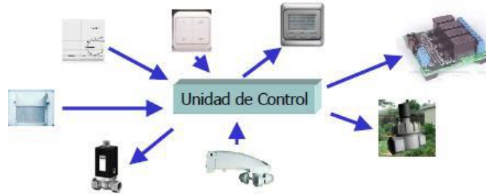
Fig. 2.13 Esquema arquitectura centralizada
