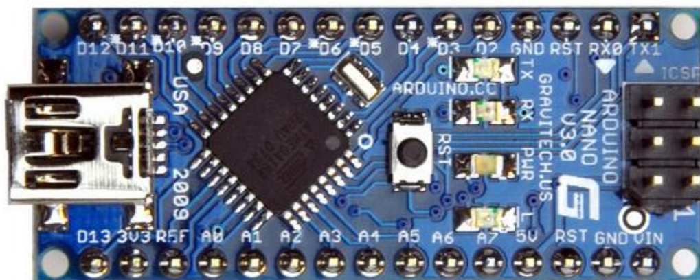
Fig. 3.6 Vista en planta de Arduino Nano revisión 3.0
