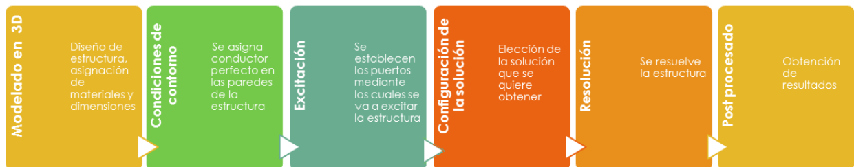
Figura 3.1: Fase de simulación en HFSS
