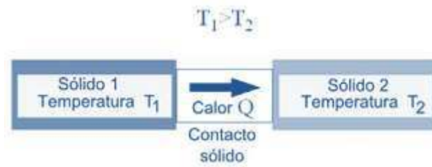
Figura. Transferencia de calor entre dos sistemas.
