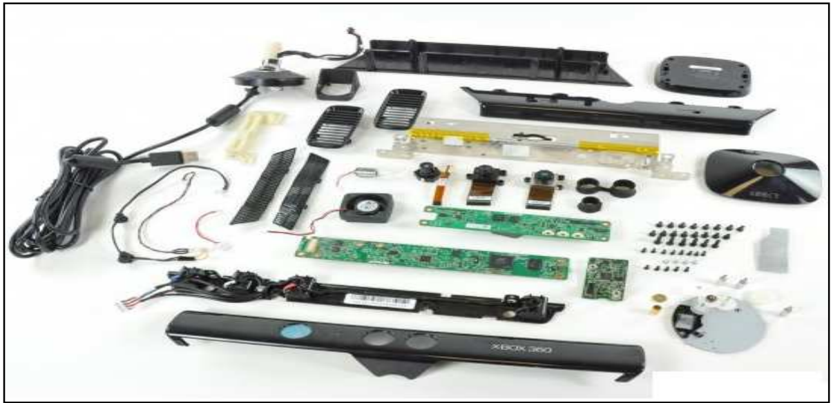
Figura 6. Kinect en Piezas.
